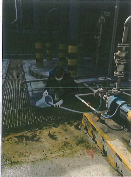
脱硫废水取水点
