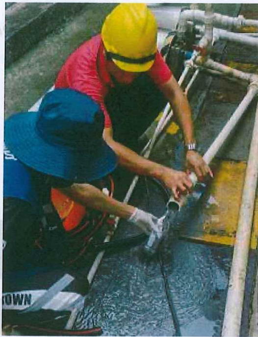
脱硫废水取水点
